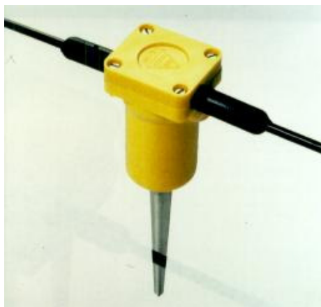
Abb.6: Ein Geophon, der einfachste und preiswerteste Sensor für Bodenerschütterungen. Es besteht im wesentlichen aus einem Permanentmagneten und einer Spule, die zwischen Membranfedern aufgehängt ist.
