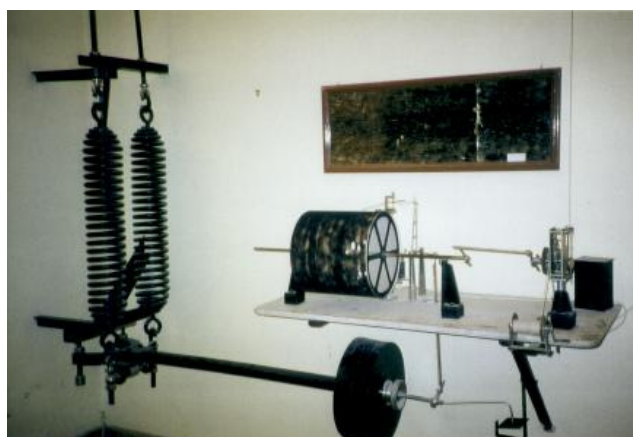
Abb.14: Der Vertikalseismograph von Cancani im Vesuvobservatorium, 1902.
