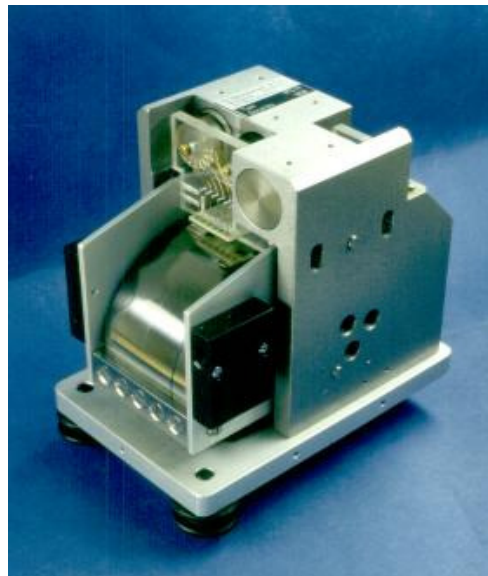
Abb.19: Das Zürcher Blattfederseismometer, eine kompaktere Version des in Abb.5 skizzierten Blattfederpendels. Die beiden schwarzen Klötze links vorn und hinten sind die seismische Masse, dazwischen die gebogene Blattfeder. Oben sind in Bohrungen zwei Tauchspulensysteme für die Kraftrückführung und der berührungsfreie Wegaufnehmer untergebracht. Unter der Feder verborgen ist ein fernbedienbares Tariergewicht.
